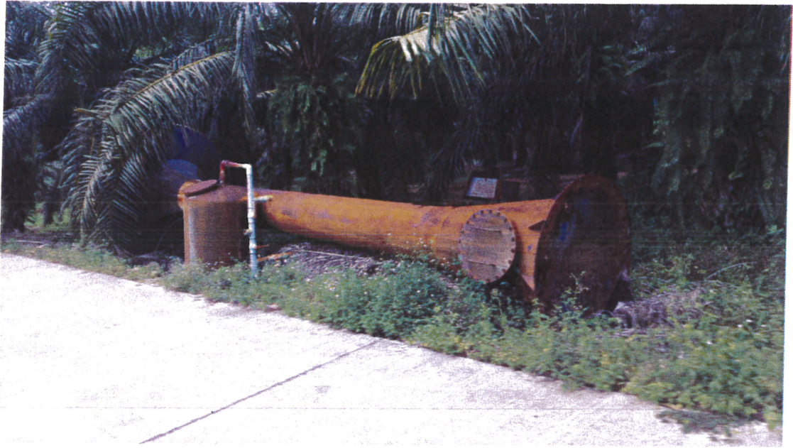
ท่อถังระบบประปาหมู่บ้าน จุดทำน้ำแข็ง หมู่ที่ 4 (ทรงบอลลูกุน) และถังกรองเหล็กระบบประปาหมู่บ้าน จุดทำน้ำแข็ง หมู่ที่ 4 (วางอยู่ที่ โรงเรียนบ้านโตนดสูง หมู่ที่ ๑)
